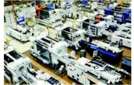
Taktmontage MX Spritzgießen
